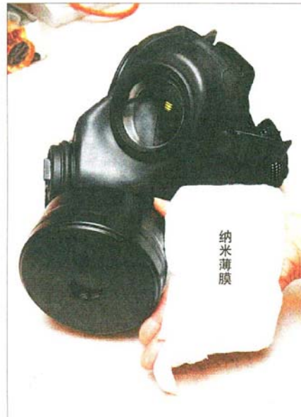
纳米薄膜可取代防毒面罩滤毒罐内的两种过滤层，所以未来的滤毒罐有望减少五成至七成的重量。
